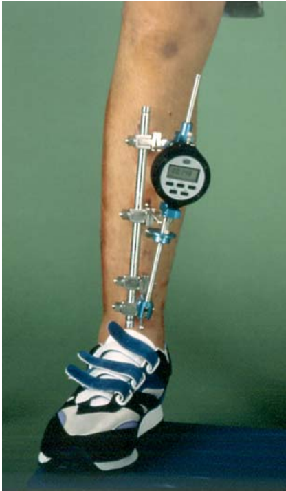
Abb. 10 Fraktometer FM 100 in situ bei der Messung der Relativbewegungen bei der Verformung der Schanz-Schrauben unter Belastung.
