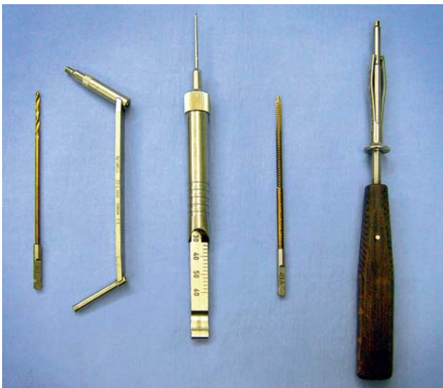
Abb. 4 Kleinfragmentinstrumentarium. 310.250: Spiralbohrer 2,5 mm; 323.360: Universalbohrbüchse 3,5; 319.010: Tiefenmessgerät; 311.320: Gewindeschneider für Kortalisschrauben 3,5 mm; 314.070: Sechskantschraubenzieher klein, 2,5 mm.
