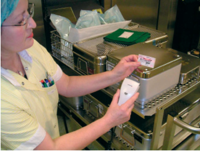
Abb. 6 Erfassen des Chargeninhalts mittels Barcode-Laser.
