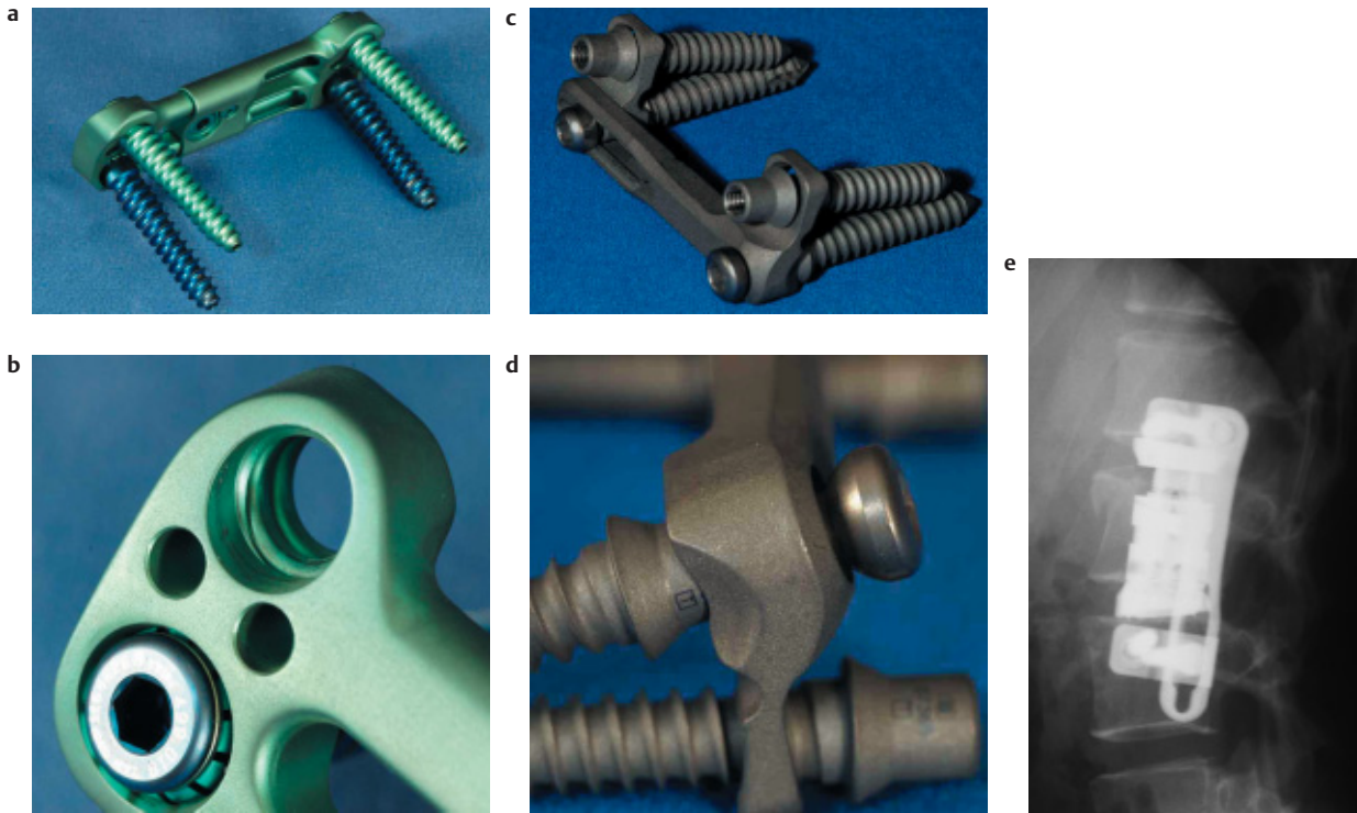
Abb. 5a–e (a,b) TeleFix®. (c–e) Centaur®. Modulare Fixationssysteme, die eine winkelstabile Schraubenverankerung im gewinde-tragenden Plattenloch bzw. durch Montage einer Sicherungsschraube auf ein zylindrisches Schraubenende erzielen.
