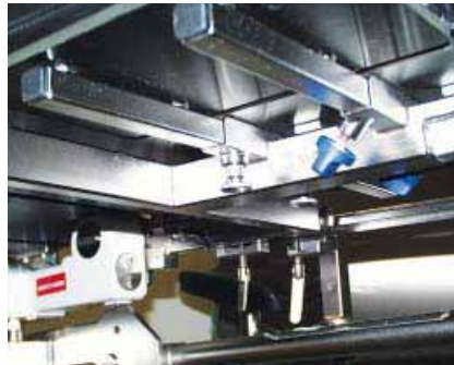
Schulterteile mit blauer Feststellschraube und kleinem Sicherheitsbolzen.
