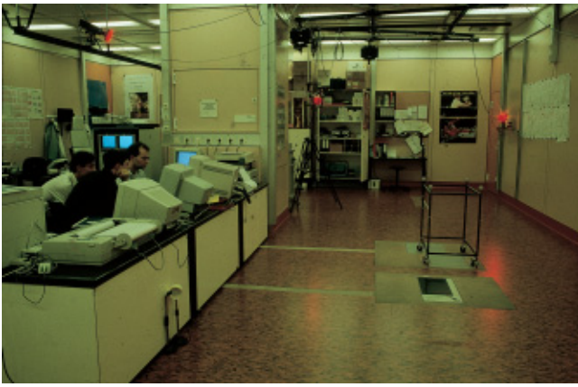
Abb. 8 Ganglabor mit optoelektronischem Video-Processorsystem, 2 Kraftmessplatten und einer Plattform zur Druckverteilungsmessung (der Laufsteg mit den integrierten Plattformen ist üblicherweise verdeckt).
