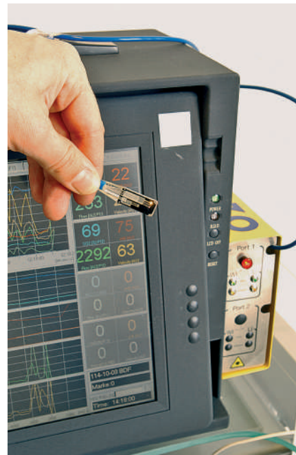
Abb. 3 O 2 C-Meßgerät zur Bestimmung der Durchblutungsparameter der Haut in unterschiedlicher Tiefe.
