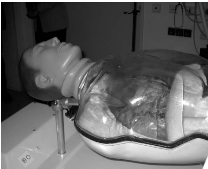
Abb. 3 Prototyp des „Erlanger Broncho-Trainer“ mit umlaufender Dichtung des Modeldeckels und einem Schweinelungenpräparat in einem luftdichten Thoraxraum. Mit einem in der Grundplatte integrierten Vakuumpumpensystem konnte erstmals ein Unterdruck im Thorax erzeugt werden, der die Lunge entfaltet.
