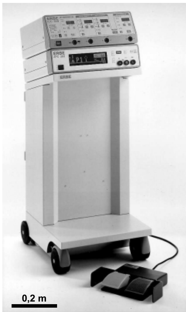
Abb. 2 Einrichtung zur Argon-Plasma-Koagulation mit Argongasquelle und HF-Generator mit Fußschalter.
