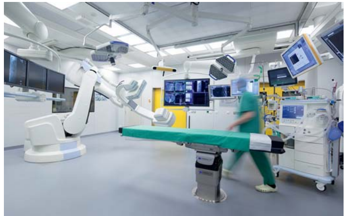
► Abb. 1 Hybrid-OP des Universitätsklinikums Ulm: Links steht der Artis zeego, der digital mit dem Operationstisch und dem Navigationssystem (deckengebunden) verbunden ist.
