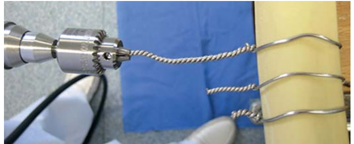
► Abb. 1 Zwirbeln einer Cerclage mit Dreibackenfutter hier mit Maschine und im Übungslabor.
