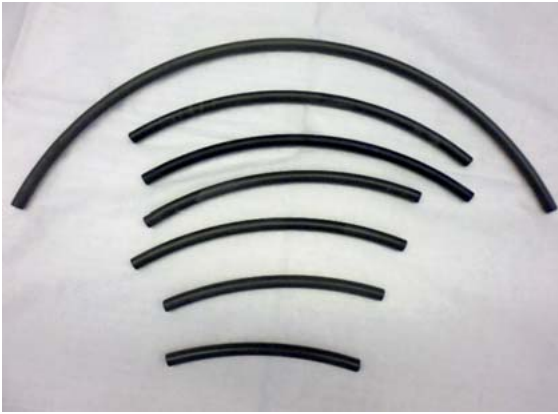
► Abb. 4 Verschieden gebogene Kohlefaserstäbe. Oben: der 180°-Bogen, danach verschiedene Längen. Wie die Schienen für die Modelleisenbahn.
