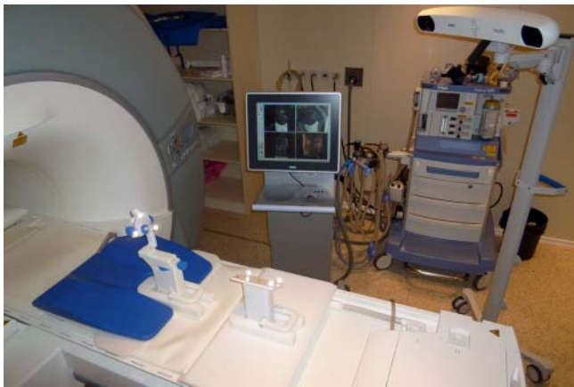
► Abb. 6 Navigationssystem für MR-geführte Prostatabiopsien in einem 3-T MRT. Nach Registrierung der Biopsievorrichtung (Invivo, Schwerin, Deutschland) rekonstruiert das System (Localite, St. Augustin, Deutschland) aus der optisch in Echtzeit erfassten Instrumentenausrichtung dazugehörige MR-Schichten und zeigt diese kontinuierlich auf dem In-Room-Monitor an.
