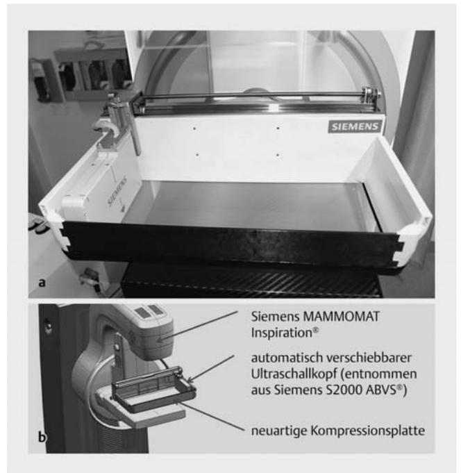
► **Abb. 2 a** Die Abbildung zeigt den an den Siemens MAMMOMAT Inspiration eingesteckten Prototyp. Der automatisch verschiebbare Ultraschallkopf, entnommen aus einem Siemens S2000 ABVS System, ist auf einer Gewindestange gelagert links im Bild zu sehen und liegt der für die Kompression notwendigen transparenten Gaze auf. **b** Schematische Darstellung der in das Mammografiegerät integrierten mobilen Schallkopf-Gaze-Einheit.
