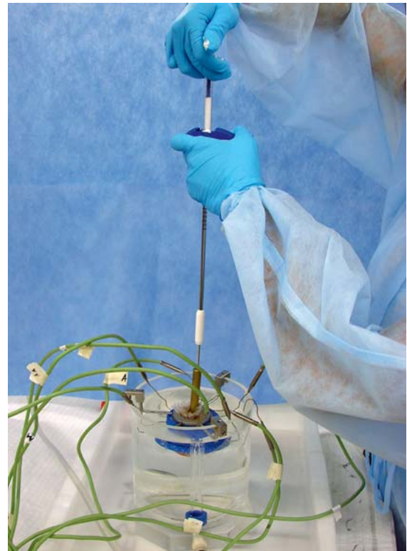
► Abb. 3 Messung der Temperaturen in einem menschlichen Femurkopf während der Injektion von 6 ml PMMA-Zement durch eine PFNA-Klinge (DePuy Synthes GmbH). Um physiologische Bedingungen zu simulieren, liegen die Proben in einem 37-°C-Wasserbad. Die Temperatursensoren sind radial um die Probe angebracht und messen in verschiedenen Tiefen, um Temperaturwerte nah und fern der Zementwolke zu erfassen [52].
