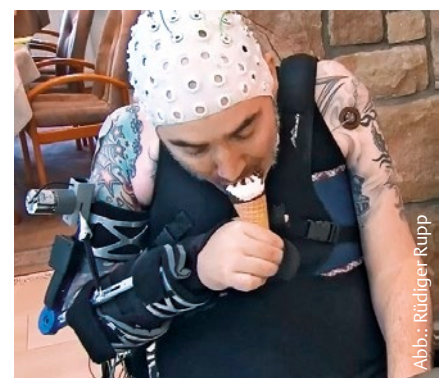
Abb. 3 Machbarkeitsnachweis einer mittels Gehirn-Computer Schnittstelle gesteuerten FES-Hybridorthese bei einem Hochquerschnittgelähmten ohne willkürliche Ellenbogen- und Handfunktion
