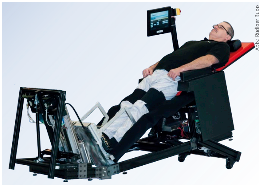
Abb. 5 Das MoreGait(Motorized Orthosis for Home Rehabilitation of Gait)-Gerät zum sicheren, effektiven robotischen Training im häuslichen Umfeld
