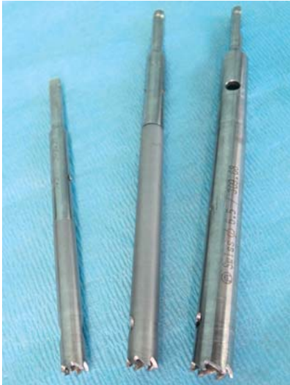
Abb. 5 Hohlfräser. Der Hohlfräser muss so gewählt werden, dass der Innendurchmesser dem Außendurchmesser eines Schraubenschafts entspricht. Er muss linkslaufend gebohrt werden. Die Konnektionsgewinde stabilisieren sich „von selbst“. Es muss weit genug vorgebohrt werden, damit dann das nächste Instrument, nämlich der linksdrehende Extraktionsbolzen, ausreichend greifen kann. Manchmal kommt der Schraubenschaft durch Verkleben bereits mit diesem Hohlfräser heraus.
