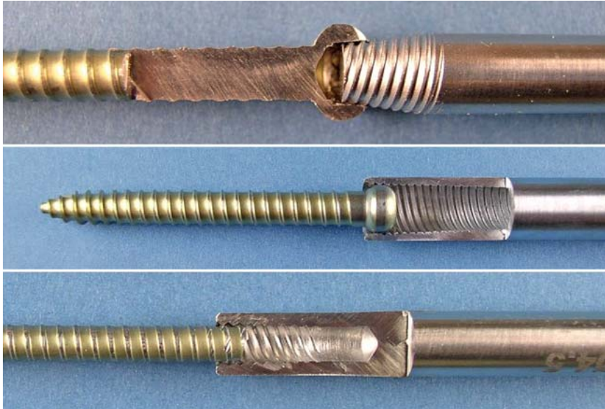
Abb. 7 Verwendung von Linksausdrehern zur Entfernung beschädigter Verriegelungsschrauben. Bei vorhandenem Schraubenkopf kann ein konisches Außen- oder Innengewinde zum Einsatz kommen (oben, Mitte). Ist der Schraubenkopf nicht mehr vorhanden oder muss er weggebohrt werden, so kann nach vorsichtigem Überfräsen ein kleineres Außengewinde verwendet werden (unten).
