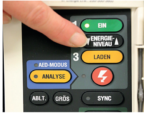
Abb. 3 Die Defibrillationsenergie wird mit Hilfe des Reglers „Energieniveau“ gewählt. Über Drücken des Knopfs „Laden“ wird der Defibrillator hochgeladen.
