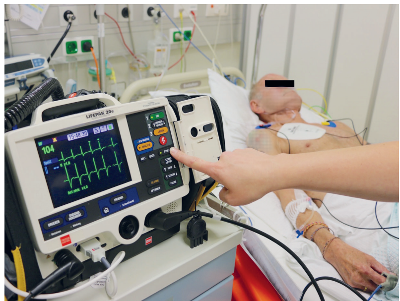
Abb. 4 Display mit Oberflächen-EKG des Patienten. Vor Kardioversion bei Vorhofflimmern muss die R-Zacken-Synchronisierung aktiviert werden.
