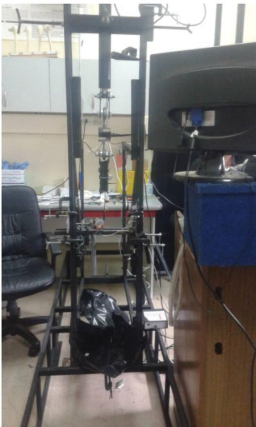
**Fig. 2** Modelo de tensión cíclica. El modelo constó de tres partes fundamentales: un soporte modular de altura regulable; un soporte ajustable para guiar el sistema de suturas; y un actuador lineal, con una celda de carga intermedia. La diáfisis humeral fue fijada en una abrazadera metálica.
