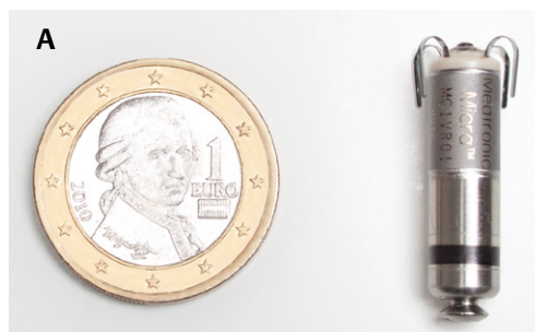
Abb. 1 Perkutan Katheter-basiert implantierbare Schrittmachersysteme. Dargestellt sind zwei 1-Kammer-VVI-Schrittmacher-Systeme, welche aktuell über einen transvenösen Zugang implantiert werden können. (A) MicraTPS (Medtronic GmbH), (B) Nanostim (St. Jude Medical GmbH).
