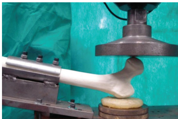
Fig. 3 Modelo experimental na plataforma de ensaio biomecânico.
