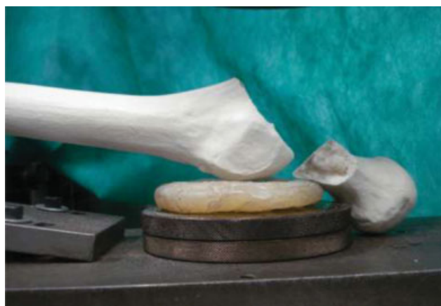
Fig. 4 Modelo sintético de fêmur com fratura basocervical.
