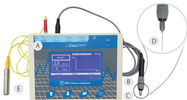
Fig. 2 Dispositivo certificado (Physio Invasiva®, PRIM Physio, Spain). (A) Dispositivo. (B) Cátodo (bisturí electroquirúrgico modificado para aguja). (C) Portaaguja. (D) Aguja. (E) Ánodo (electrodo de mano).
