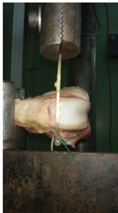
Fig. 1 Visão anterior de fêmur suíno esquerdo com enxerto sendo testado colocado perpendicularmente sob tração na máquina universal de ensaio de tração. Autores, 2017.
