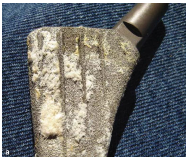
Fig. 2 Fotografias de uma haste Logical removida devido a infecção. Imagens demonstrando nítido crescimento ósseo para a superfície porosa da haste.
