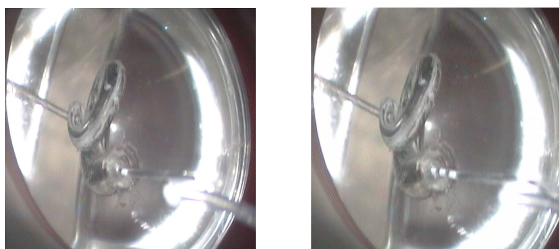
Fig. 1: links: die CI Elektrode 532 nach kompletter Insertion, der dritte Marker ist im Niveau des runden Fensters; rechts: nach ‚pullback‘, der mittlere Marker ist im runden Fenster.
