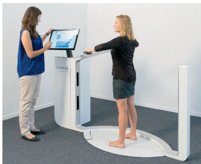
Abb. Digitales Präzisionsmessgerät von Sigvaris zur Bestimmung der Beinmaße
