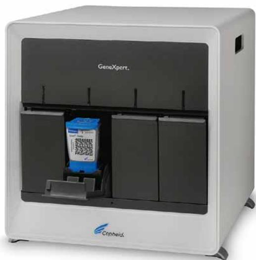
**Spürt MRSA in maximal zwei Stunden auf:** Dieses Gerät gehört zu dem Schnelltest von Multiresistenten Erregern des US-amerikanischen Unternehmens Cepheid. Es ist Marktführer in diesem Bereich.
