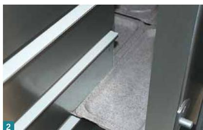
Die Andockstation enthält einen Trennsteg, der sich beim Einschieben des Tablett in die Tablettfuge schiebt. Das gewährleistet die thermische Trennung von warmen und kalten Komponenten.
