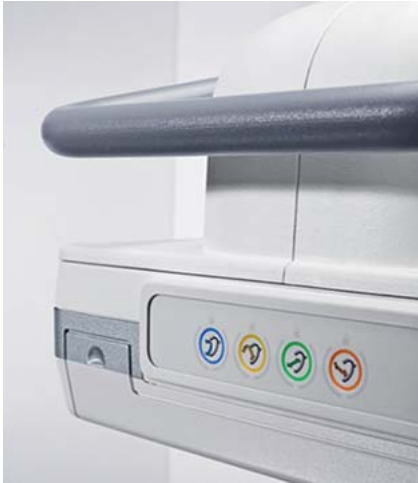
Abb. 11 Bremssteuerung am Flachdetektor ermöglicht dem Chirurgen, den C-Bogen ohne Hilfe Dritter in die gewünschte Position zu manövrieren.
