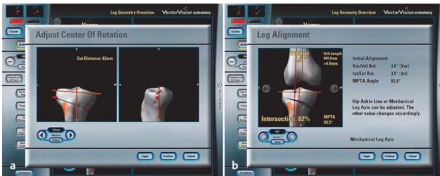
Abb. 6a und b Nach der Osteotomie stehen dem Operateur Echtzeitinformationen über die Beinachse zur Verfügung. Damit kann die gewünschte neue Beinachse exakt eingestellt und fixiert werden.
