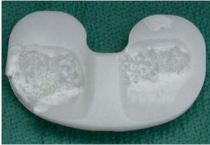
Abb. 1 PE Abrieb Schaden.
