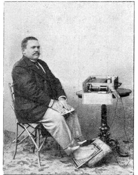
Eine zweite Metallplatte e, die ebenfalls als Elektrode dient, deckt zum Teil ein Fach, in welchem zwei größere Metallzylinder k als Handelektroden mit den zugehörigen Leitungsschnüren l aufbewahrt werden.
