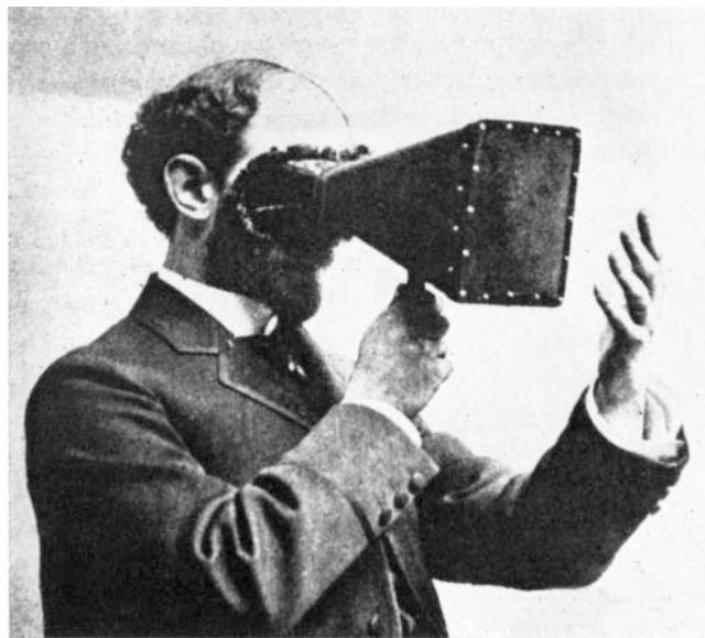
► Fig. 6 Early fluoroscope using Edison’s design (© Deutsches Röntgen-Museum Remscheid). [rerif]
