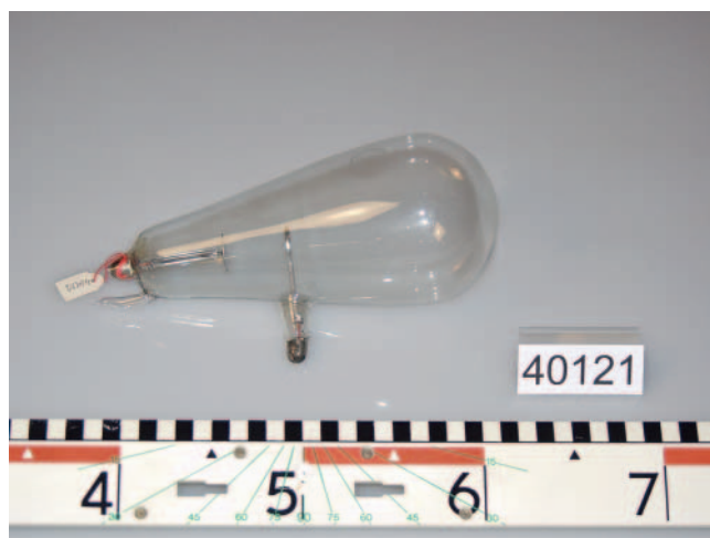
► Fig. 3 Pear-shaped Crookes–Hittorf tube. (© Deutsches Röntgen-Museum Remscheid). [rerif]
