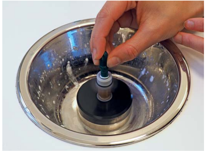
► Abb. 9 Poliereinrichtung für formstabile Kontaktlinsen.
