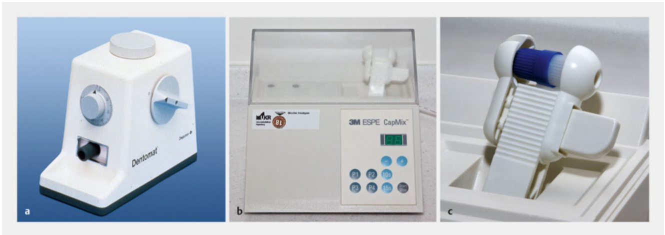
► Abb. 6 a Während man Amalgatoren mit Quecksilber und einem Legierungspulver befüllen musste und durch das Mischverhältnis die Konsistenz bzw. die Materialqualität beeinflusste, werden heutzutage gebrauchsfertige Amalgamkapseln in handelsüblichen Kapselmischern geschüttelt (b, c). Man erhält dabei stets ein optimales Mischverhältnis und das angemischte Amalgam ist von gleichbleibender Qualität. Auch der Kontakt zu Quecksilber kann so minimiert werden.
